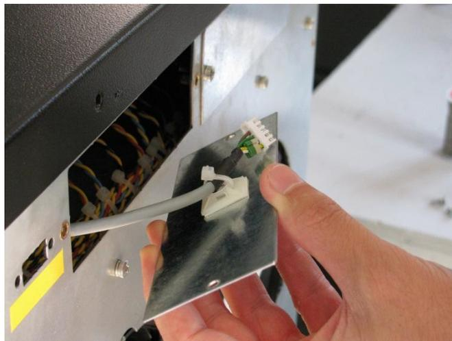
2. Открепите разъем от защитной панели и подключите его к разъему J3 платы сухих контактов.
