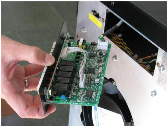
4. Нажмите на фиксатор клеммной колодки с помощью отвертки и подключите кабель к разъему модуля.
