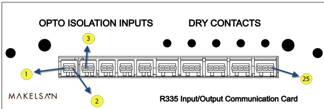
Как показано на рисунке выше, модуль имеет 25 входных/выходных контактов. Функционал выводов приведен в следующей таблице.
