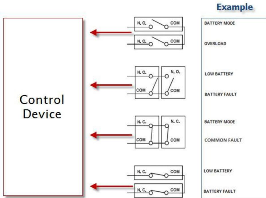
Конфигурации «И» и «ИЛИ» могут быть установлены с помощью реле, путем подключения их контактов последовательно или параллельно, как показано на рисунке выше.
